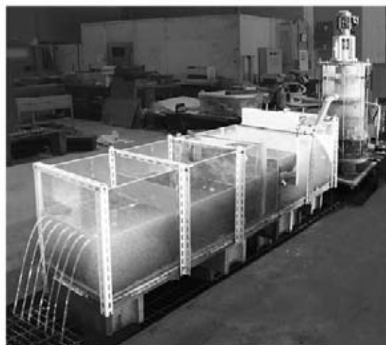
図-11 試作2号機(450型)と固液分離実験装置 水処理能力 100 ℓ / min
