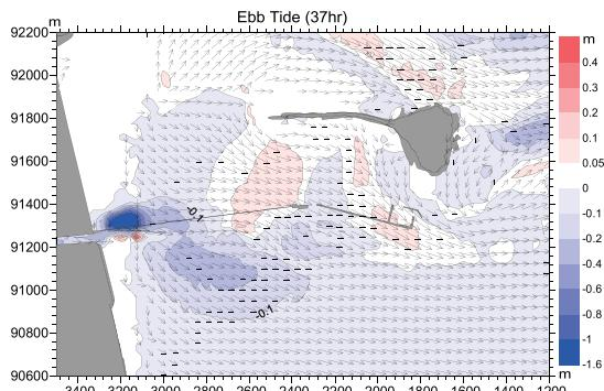
図-18 CASE2 の小領域における流速ベクトル図と差流速図（下げ潮時）
