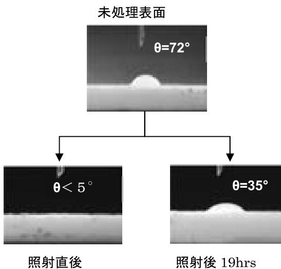
図8 中性 Ar 粒子照射(300秒)によるアルミナ表面の改質効果。大気中露出後の接触角
