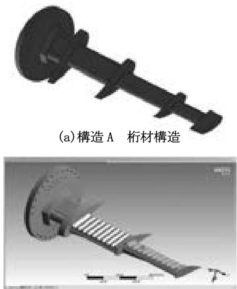
図 2. ブレード桁材構造
