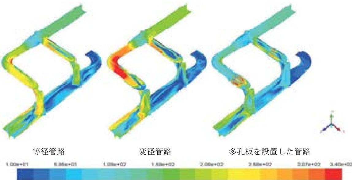
図-7 管路流速分布コンター図 (単位 : m/s)
