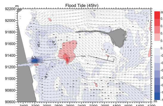
図-20 CASE2 の小領域における流速ベクトル図と差流速図（上げ潮時）
