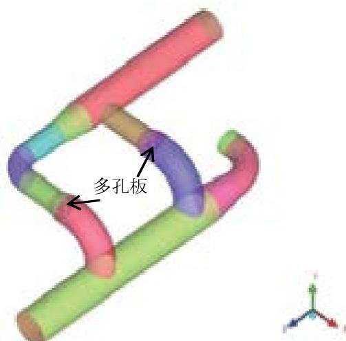
図-6 多孔板の設置イメージ図
