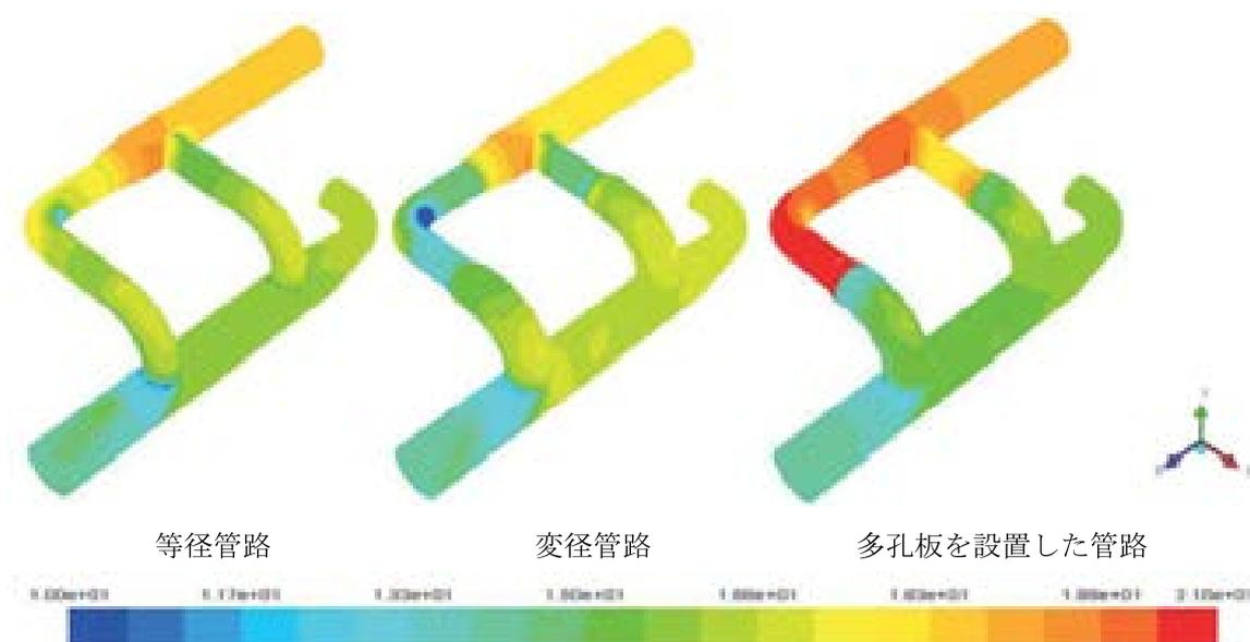
図-8 管路圧力分布コンター図 (単位 : atm)
