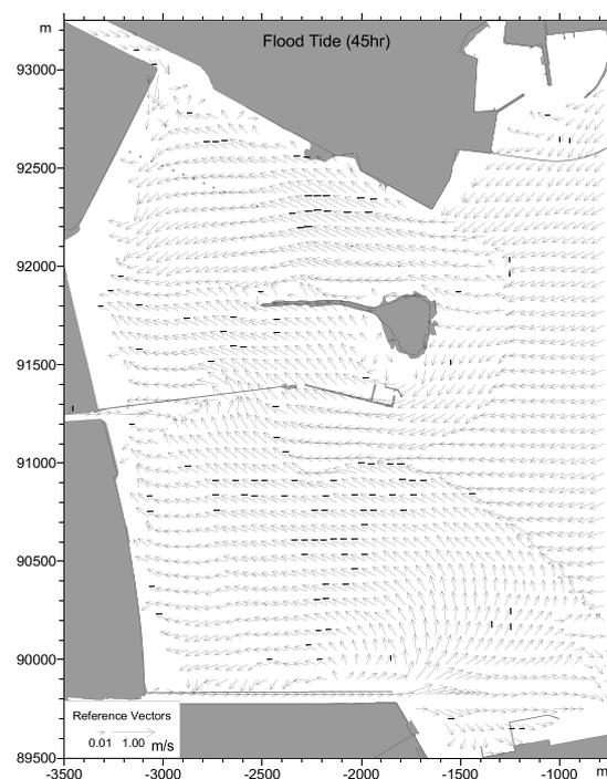
図-19 CASE2 の中領域における流速ベクトル図（上げ潮時）
