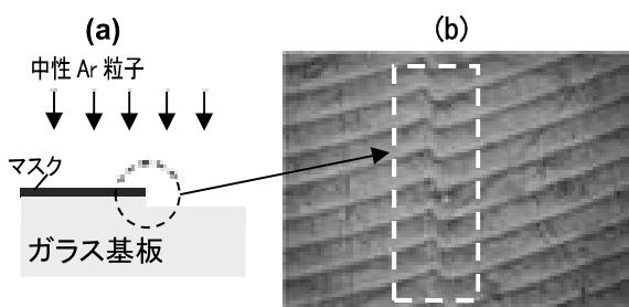
図6 中性 Ar 粒子照射によるガラス試料表面のエッチング。
