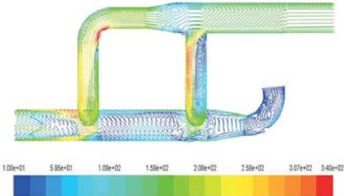
図-4 管路流速ベクトル図 (単位 : m/s)
