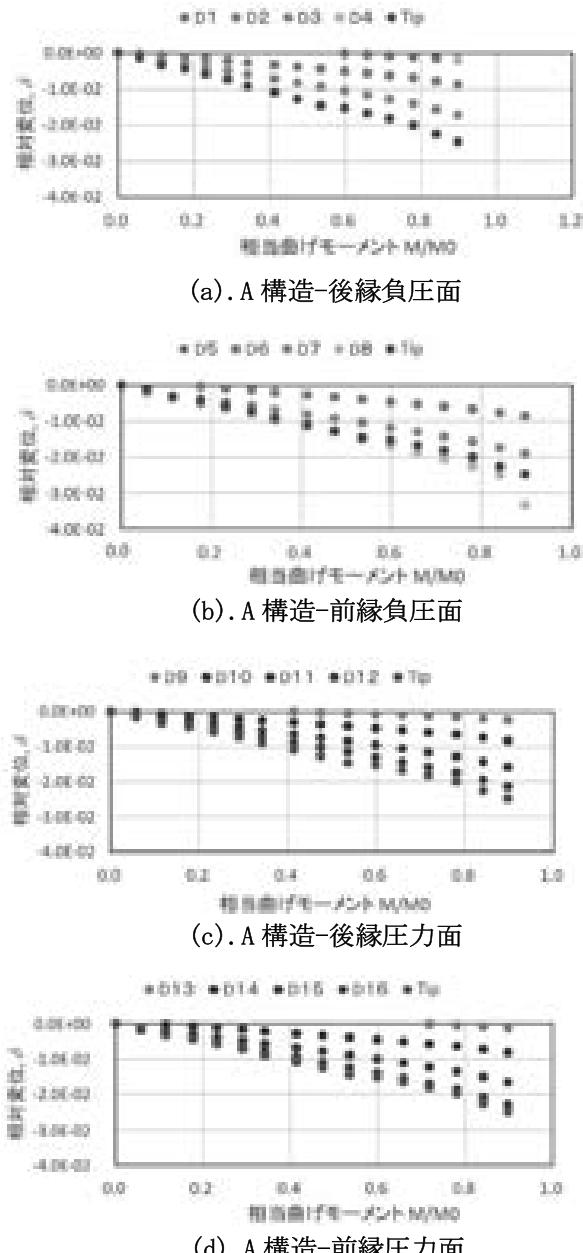
図 9. 構造 A 曲げ試験結果
