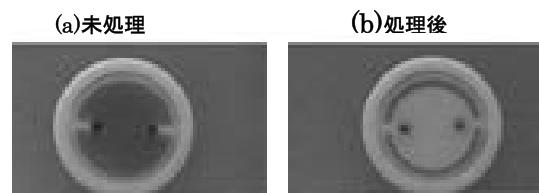
図4 (a) : W フィラメントの消耗によって汚染された走査電子顕微鏡用フィラメント取り付けセラミックス表面の写真。(b) : 格子状カーボンカソード電圧-電流を-800V-200mAに保ち10分間照射処理後の写真。
