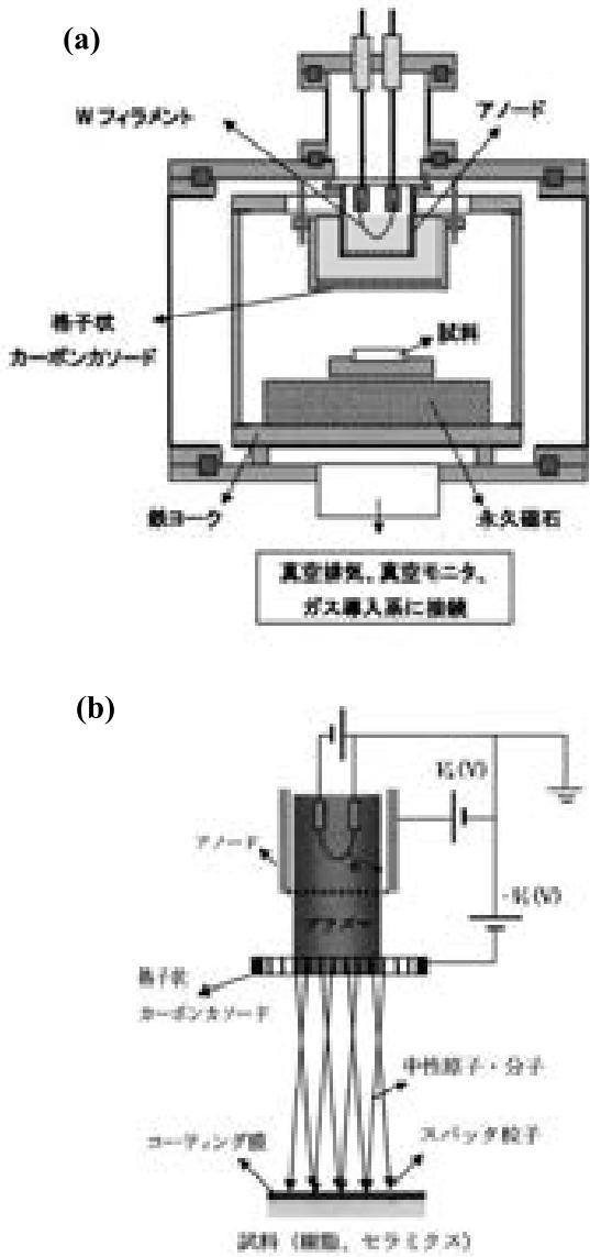
図 1 高エネルギー中性原子・分子生成法の概略
