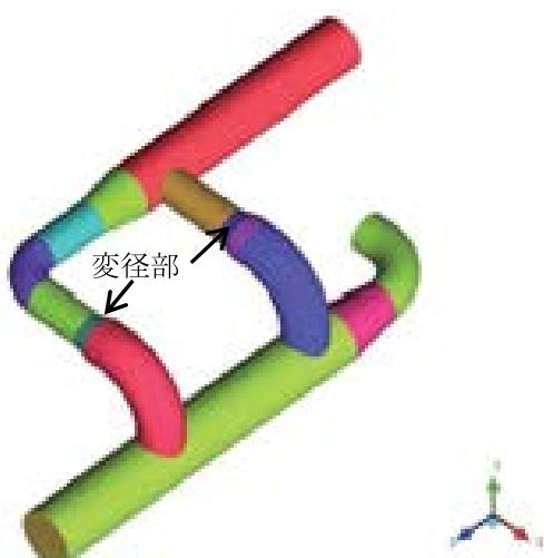
図-5 管径変更イメージ図
