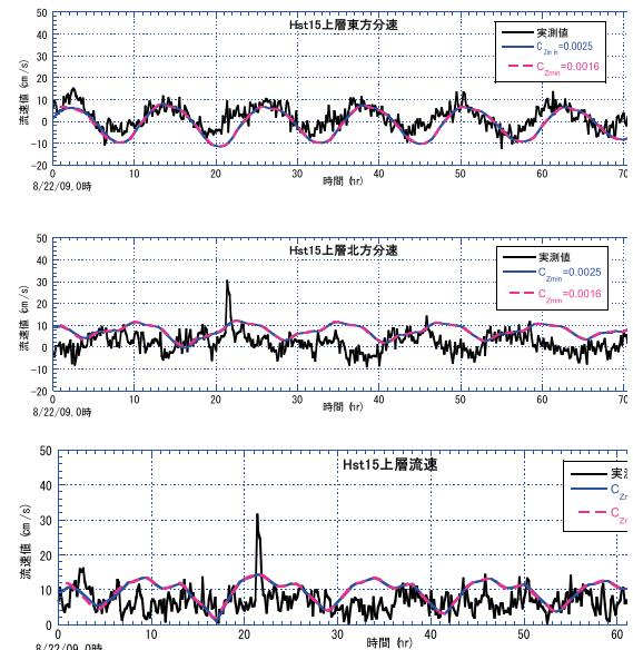
図-11 抵抗係数の違いによる実測値と計算値の比較(大潮時；上層、上図；東方分速、中図；北方分速、下図；流速)
