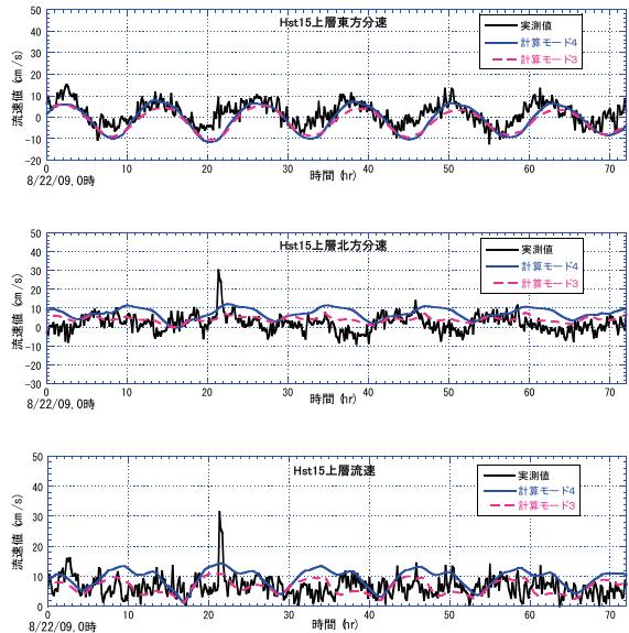
図-10 計算モードの違い(3と4)による実測値と計算値の比較(大潮時；上層、上図；東方分速、中図；北方分速、下図；流速)
