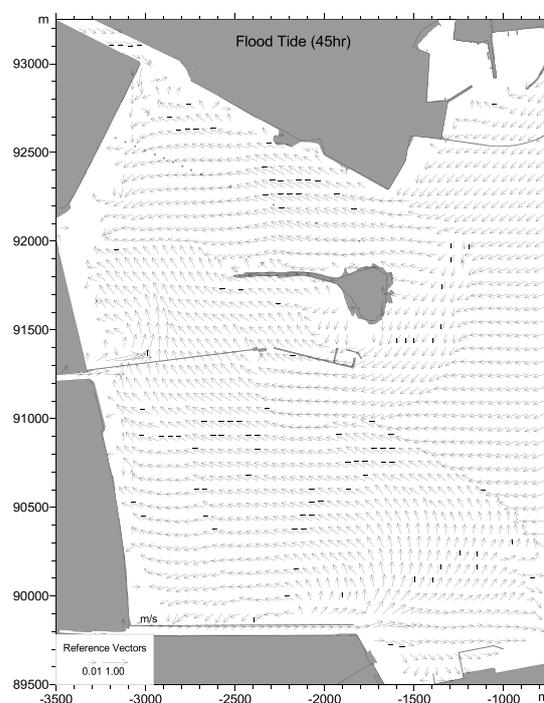
図-15 CASE1の中領域における流速ベクトル図（上げ潮時）
