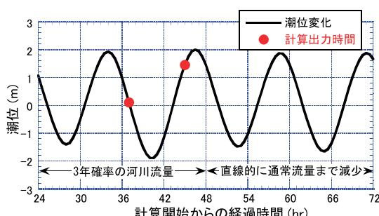
図-12 計算出力時の潮位と河川流量の条件
