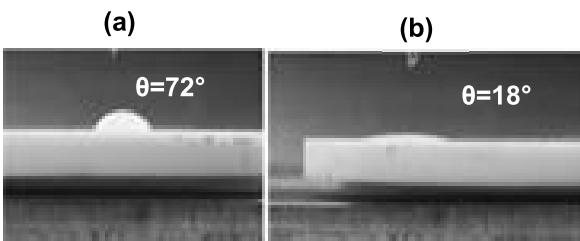
図7 中性 Ar 粒子照射（180 秒）によるアルミナ表面の改質効果
