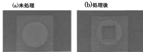
図3 (a) : 50nm の ITO 膜を円形状に成膜した透明樹脂基板表面の写真。
