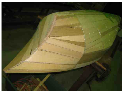
ラワン合板 貼り付け完了
