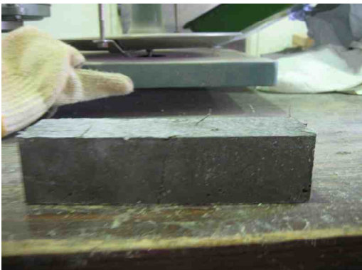
圧縮試験終了後の供試体だが、それほどひび割れはみられなかった。
