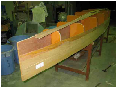
ラワン合板貼り付け全体の3分の1終了
