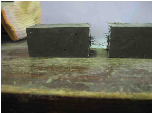
引っ張り試験完了後の供試体の様子
