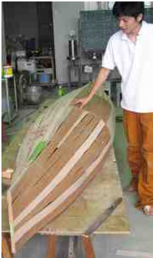
3 mmのラワン合板 T1F3、貼り付け完了。
