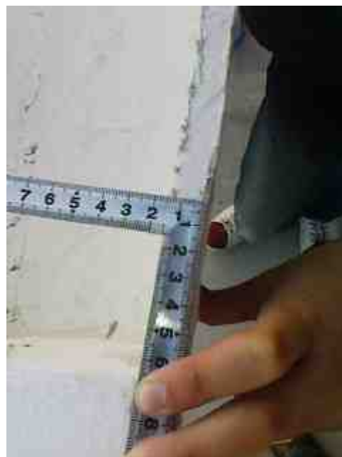
カヌー中心 右側壁厚 実厚 16 mm 設計厚 10 mm
