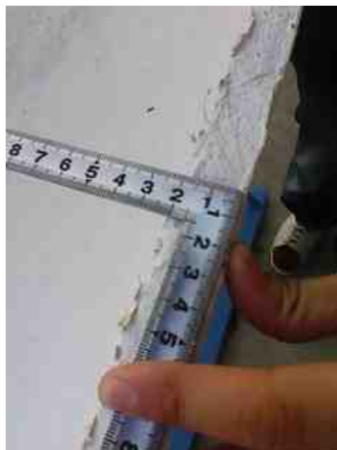
カヌー船尾 左側壁厚 実厚 21 mm 設計厚 10 mm
