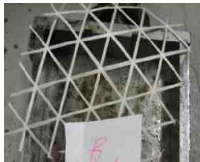
図 - 2 ビニロン繊維のラス補強材
