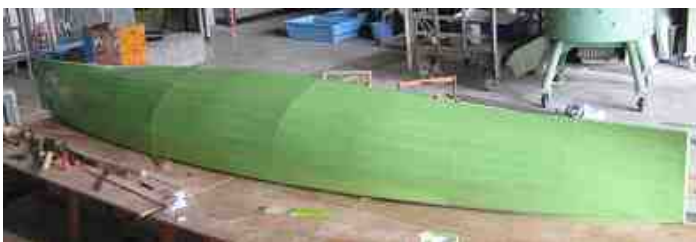
養生テープ貼り付け完了。
