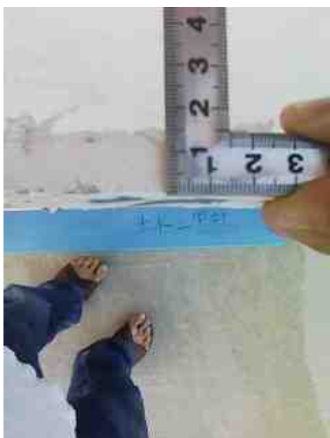
カヌー船首 右側壁厚 実厚 17 mm 設計厚 10 mm
