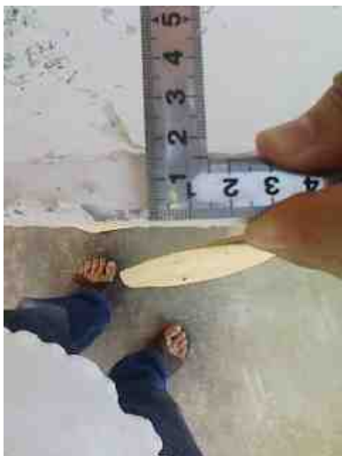
カヌー中心 左側壁厚 実厚 17 mm 設計厚 10 mm
