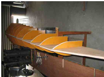
型枠組み立て完了(EKO号)
