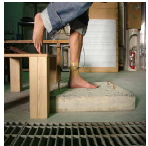
写真-2 足の落下試験
