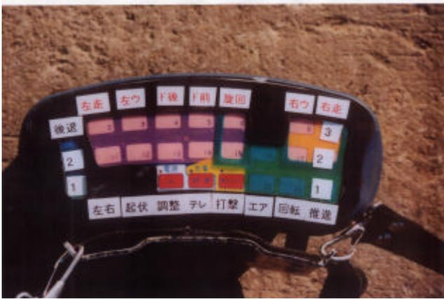
写真 - 2 : 掘削機械のリモコン
