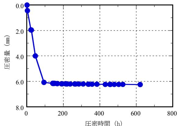
図-3 圧密量と圧密時間 ( $\sigma_0 = 157\text{kPa}$ 時)
