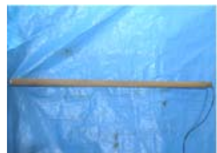
図-2 模型杭(摩擦杭)
