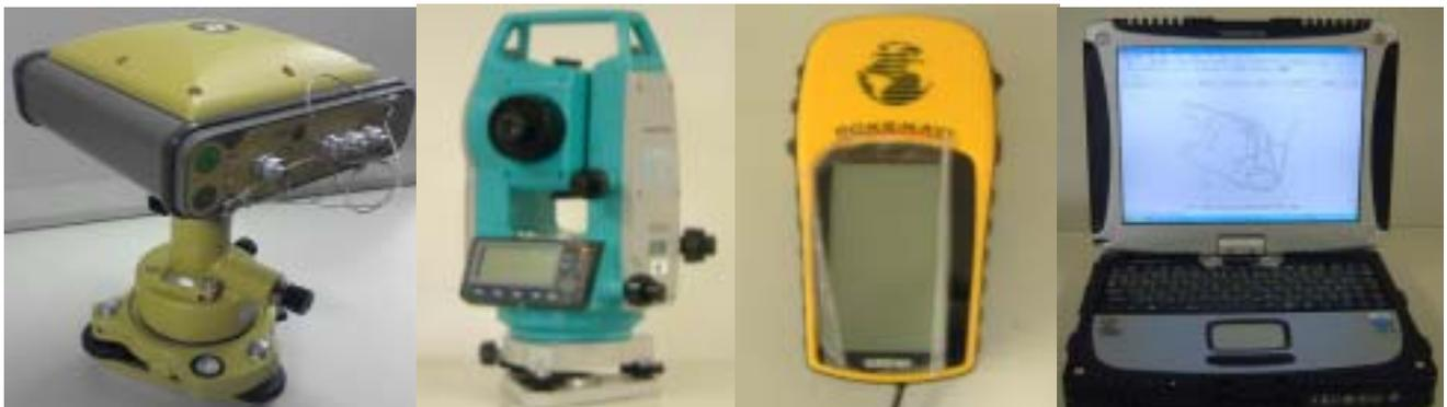
写真 - 1 デジタル測量器機類の概観(左よりGPS・TS・ポケナビ・電子平板)
