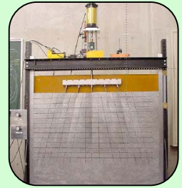
地盤実験室 傾斜群杭実験装置
