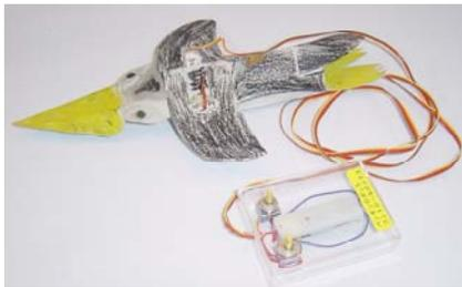
動物やキャラクター(ペンギンやクワガタなど)をボール紙で作し、その胴体の両端に2個のマブチモータを両面テープで貼り付け、電池で動かします。コントロールボックスの2つのスイッチを組みあわせて操作すると前後、左右方向にすばやく自由に動かせます。
