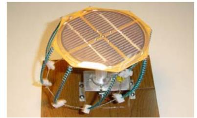
円形のソーラー電池に太陽光があたると発電して、ソーラー電池が回転してメリーゴーラウンドとなります。\* チェーンの下に各自用意してきた、好きな動物やキャラクターを取り付けることができます。(高 学年向き)
