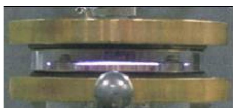
図3 RF 電力 50W における平板型 He プラズマの外観
