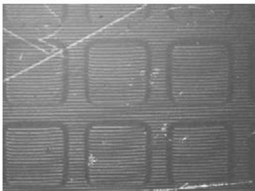
図9 パターンマスク(図3(c))によりポリカーボネート基板表面に作製した段差パターンの多重反射干渉法による観察結果。段差:630nm。窒素分子のエネルギー:900eV(イオン電流 12mA)、スパッタリング時間:15分。
