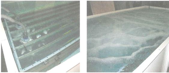
写真-1 超微細気泡散気装置
