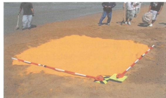
図-13 P-1の黄色の蛍光砂の投入状況（8月7日撮影）
