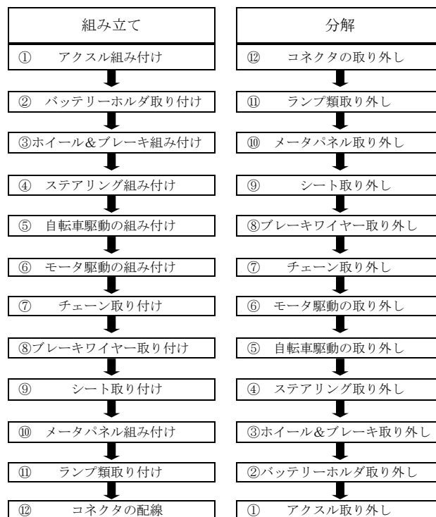
図3 組み立ておよび分解のフローチャート
