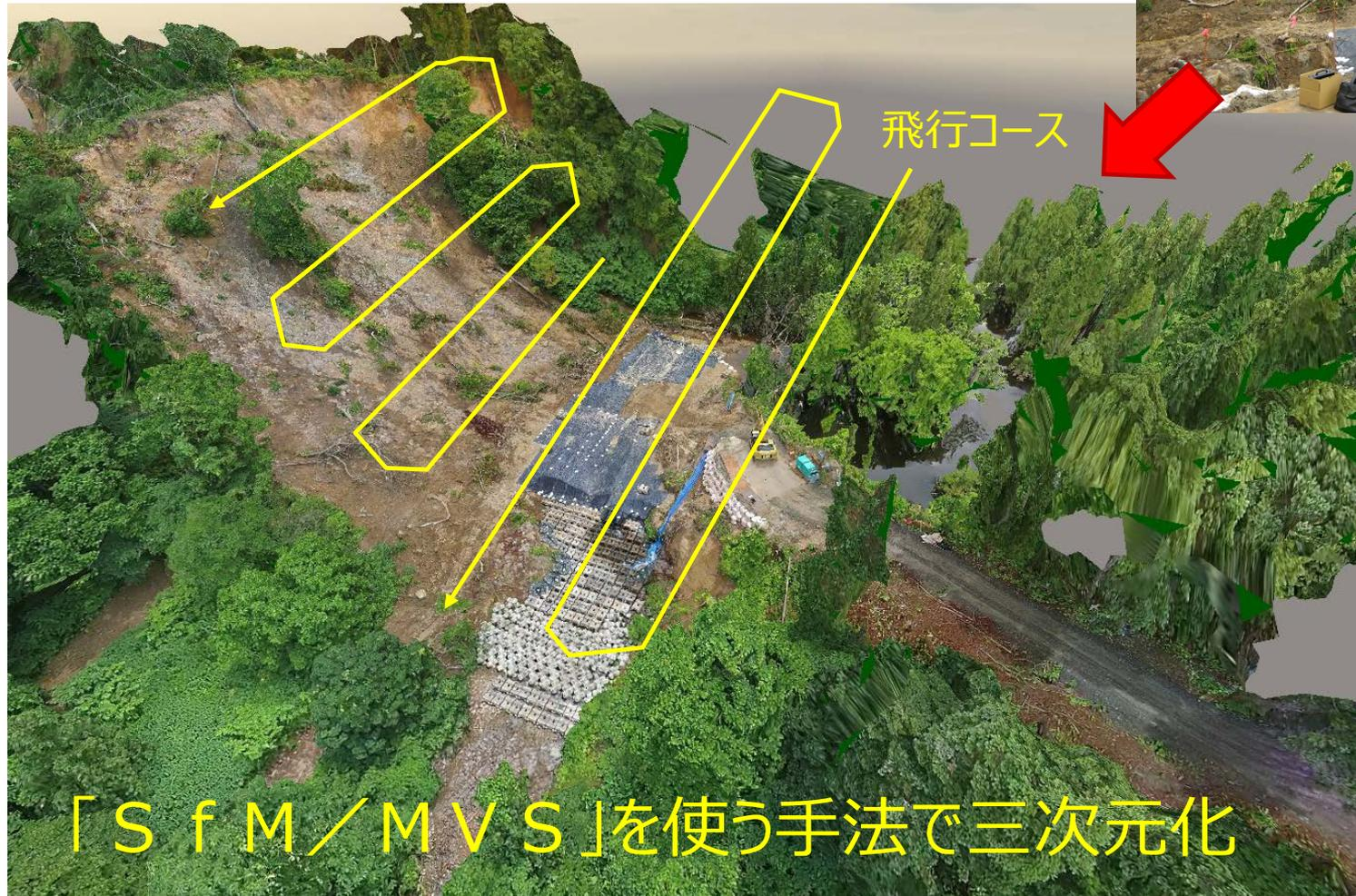
「S f M / M V S」を使う手法で三次元化
